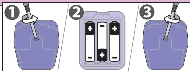
1. Откройте крышку отсека элементов питания с помощью отвертки.
