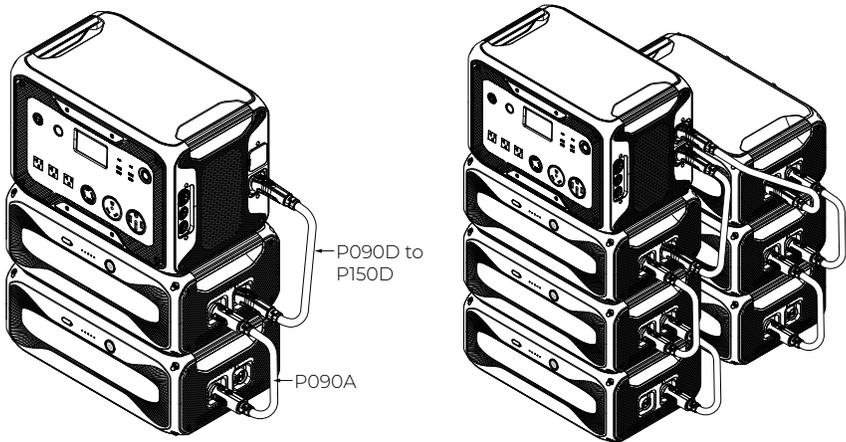
**Hinweis:** Der AC500 kann gleichzeitig mit den Erweiterungsbatterien B300K, B300S und B300 betrieben werden. So schließen Sie sie an:
