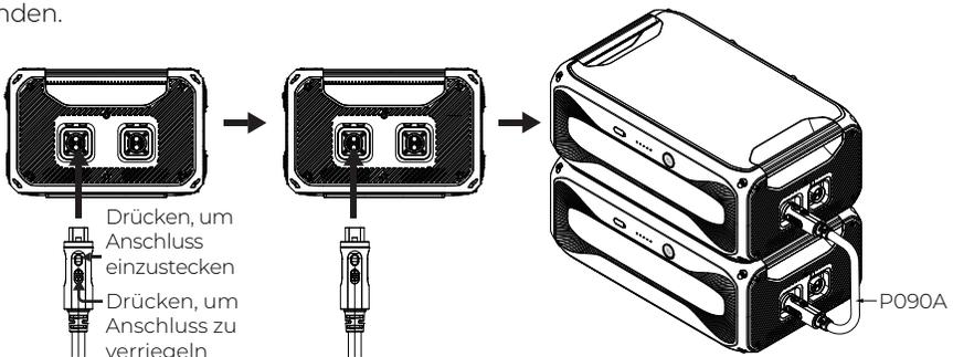
\*Stellen Sie sicher, dass die Verbindung SPERRT ist.
