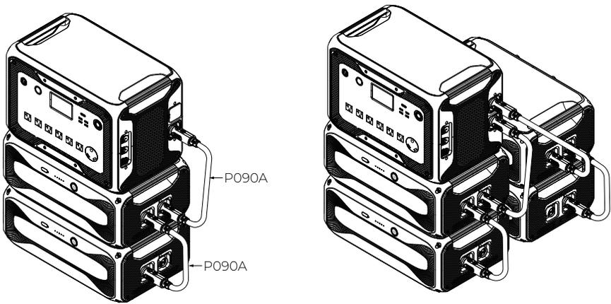
**Hinweis:** Der AC300 kann mithilfe der Batterieerweiterungskabel P090A gleichzeitig mit B300K- und B300-Erweiterungsbatterien betrieben werden.
