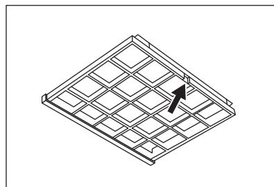
3. Führen Sie zum Einbau des Filters die gleichen Schritte in umgekehrter Reihenfolge durch.
