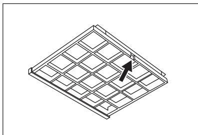
3. Při instalaci filtru provedte stejný postup v opačném pořadí.
