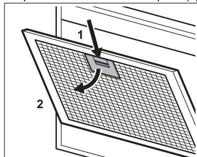
2. Inclineu lleugerament la part frontal del filtre cap avall (2) i, a continuació, estireu. Repetiu els dos primers passos per a tots els filtres.
